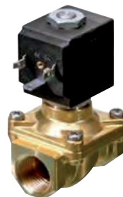
2-Wege Servo-Magnetventil, angetriebene Membran, Messinggehäuse.
