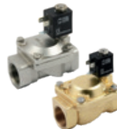
Electroválvulas servoasistidas de 2 vías, membrana, cuerpo de latón o acero inoxidable.
